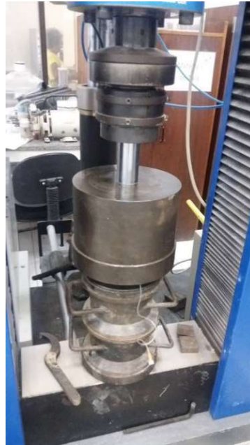
Figura 8 - Dispositivo acoplado na prensa hidráulica para extração da água de poro dos corpos de prova de pastas cimentícias.
